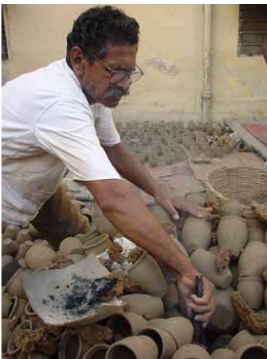
(写真19) 火をつけた牛糞を、窯の中心部に入れる (Ramberg Bazaarにて)
