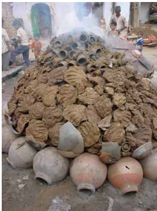
(写真20) 窯全体を牛糞でカバーする (Ramberg Bazaarにて)
