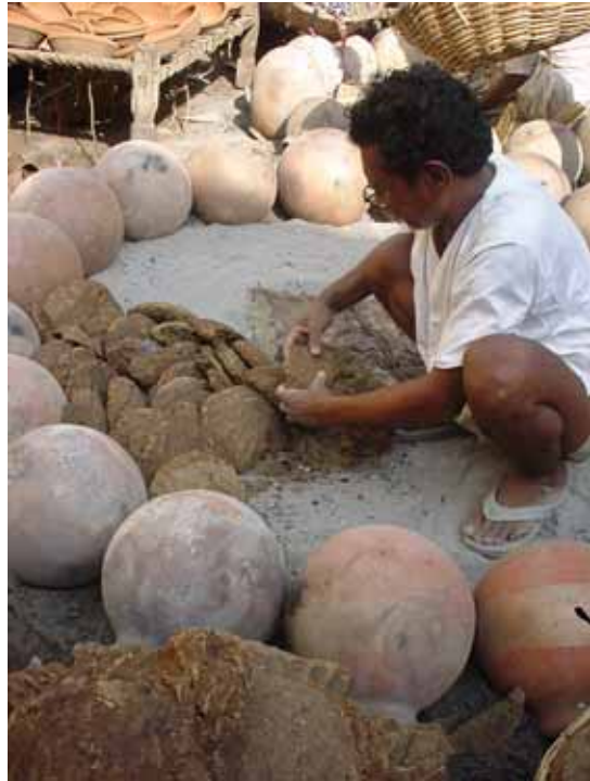
(写真15) 地面に燃料の牛糞を並べる (Ramberg Bazaarにて)
