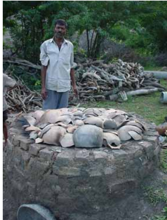
(写真 23) マルカを焼成するレンガ作りの窯 (Amer Roadにて)
