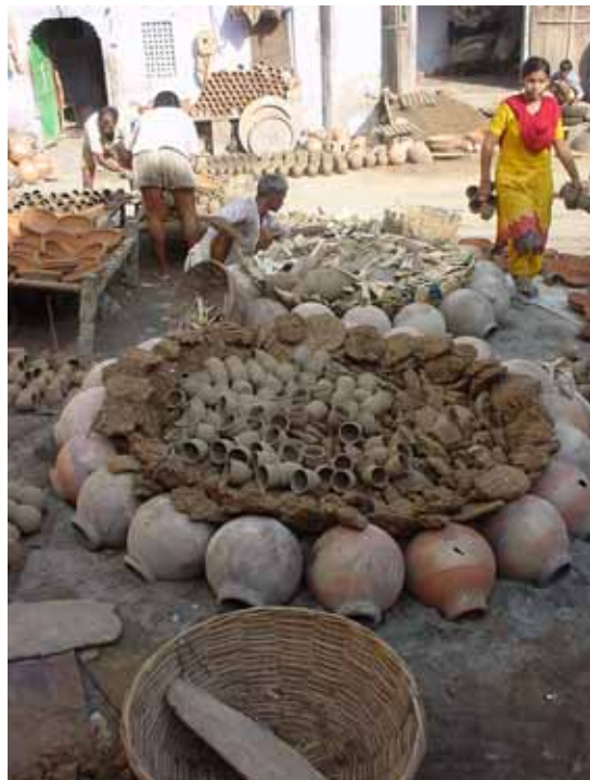
(写真16) 敷き詰めた牛糞の上に、製品を置く (Ramberg Bazaarにて)
