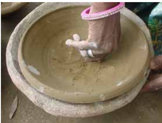
(写真9) 指で穴のある底面部を伸ばす (Nahri Ka Kankaにて)
