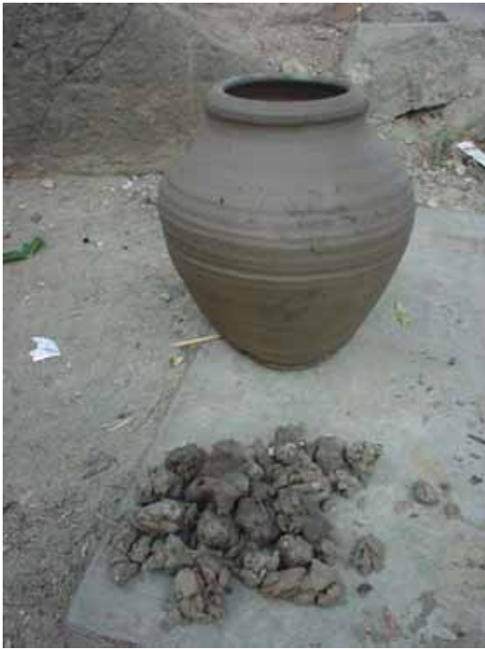
(写真11) ロクロから切り離し乾かした壺。この壺を叩きマルカにする (Amer Roadにて)
