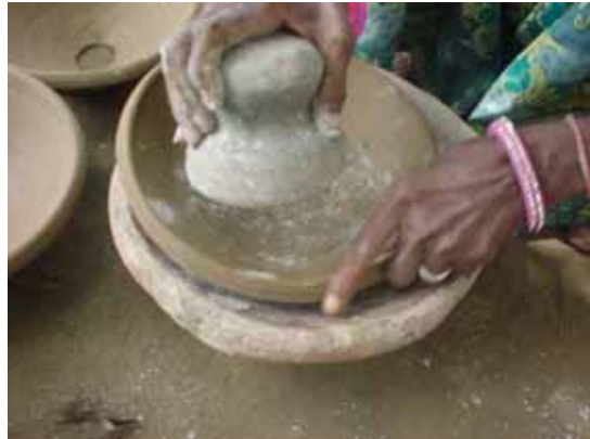
(写真10) 叩き板の上に置いた平皿を、当て具で叩き伸ばす (Nahri Ka Kankaにて)
